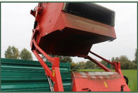
Schritt 3: Nach dem Vertikutieren werden die überschüssigen Reste (Filz, Moos, Wurzeln) ausgeleert.
