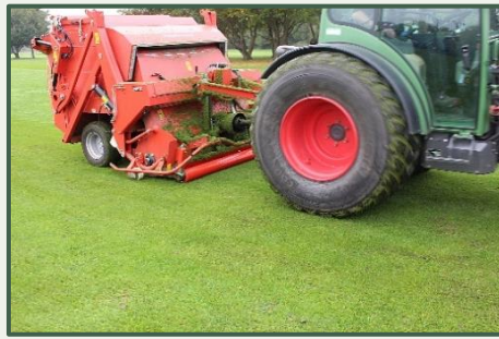
Schritt 2: Der Vertikutierer fährt über die Rasenfläche und ritz die Grasnarbe an.
